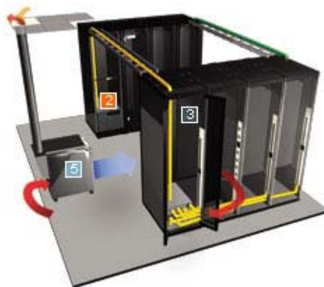
Figure 3 –InfraStruXure Type A classique déployée dans un répartiteur principal à huit racks
